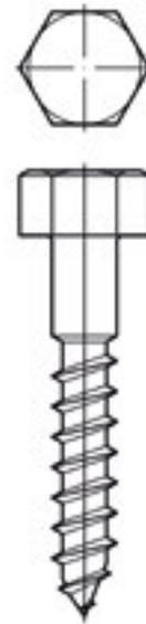
Los tornillos **Tirafondo** con cabeza hexagonal **se utilizan para ensamblar maderas y también para fijaciones con tarugos plásticos.**
