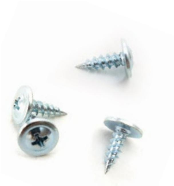
Los tornillos cabeza tanque punta aguja PH 2 **perforan y hacen la rosca en un solo paso. Unen perfiles metálicos menores a los 0,90 mm de espesor.** Son ideales para las construcciones en seco o en el sistema **steel frame**.
